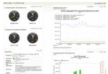
SolarWinds NPMのウェブインターフェースでは、ネットワークパフォーマンスと可用性の統計をリアルタイムビューで確認でき、詳細のモニタリングと、ルーター、スイッチ、サーバーおよびその他のSNMPをサポートするデバイスからのデータ分析も確認できます。このパフォーマンスモニタリングデータは、トラフィックの遅延、パケットの損失、デバイスの障害などネットワーク状態が悪化した場合に、アラートで警告します。
